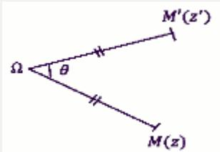
Soit  $\theta \in \mathbb{R}$ . Et soit  $\Omega$  le point d'affixe  $\omega$ . Alors la transformation  $z \rightarrow e^{i\theta}(z - \omega) + \omega$  est la rotation d'angle  $\theta$  et de centre  $\Omega$ .
